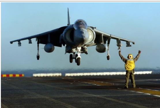
도표 14. Harrier II (AV-8B) 수직 이착륙기
